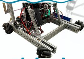
Nous l'avons remplacée tout d'abord par un **châssis mecanum**, car ses roues lui permettent d'aller dans **toutes les directions** et de **tourner sur lui-même**. Le problème majeur de cette base est la **difficulté** de la **programmation** : le **patinage** permanent des roues du châssis, et la **perte d'énergie** de 40% des moteurs.
