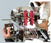
**1** Dès que nous avons construit le StarterBot, nous avons noté l'importance de **changer d'intake**, car le mécanisme proposé par REV n'était ni très efficace ni très fiable. De plus, il était assez lent.
