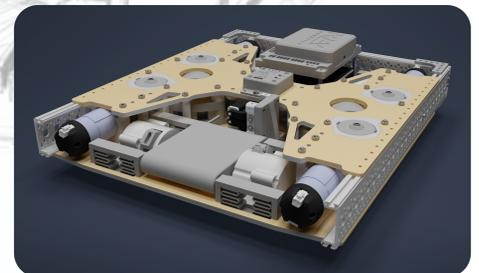
La **programmation** est également innovante. En effet, elle permet de réaliser un mouvement de **rotation** tout en faisant **avancer** le robot avec seulement **2 swerves**, alors que ce mouvement très particulier s'effectue normalement avec **4** !
